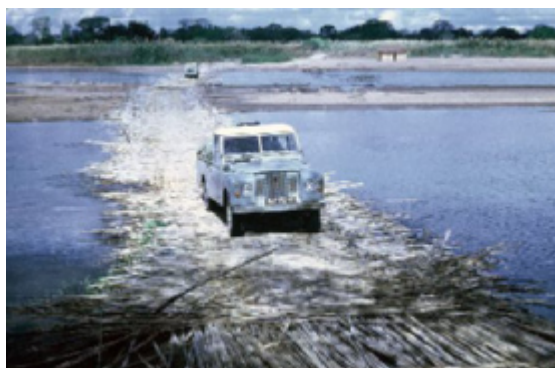
Franchissement de fleuve sur tapis flottant de bambous
